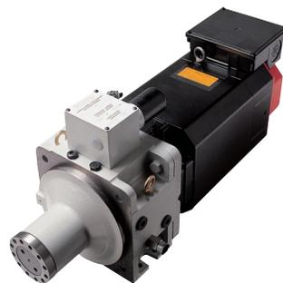
37 kW 主轴马达直接与 Baruffaldi 双速电子变速箱连接,提供最大扭矩。经精密磨齿的双速变速器在高速下低音工作,无振动传递功率,加工表面光洁度高。
